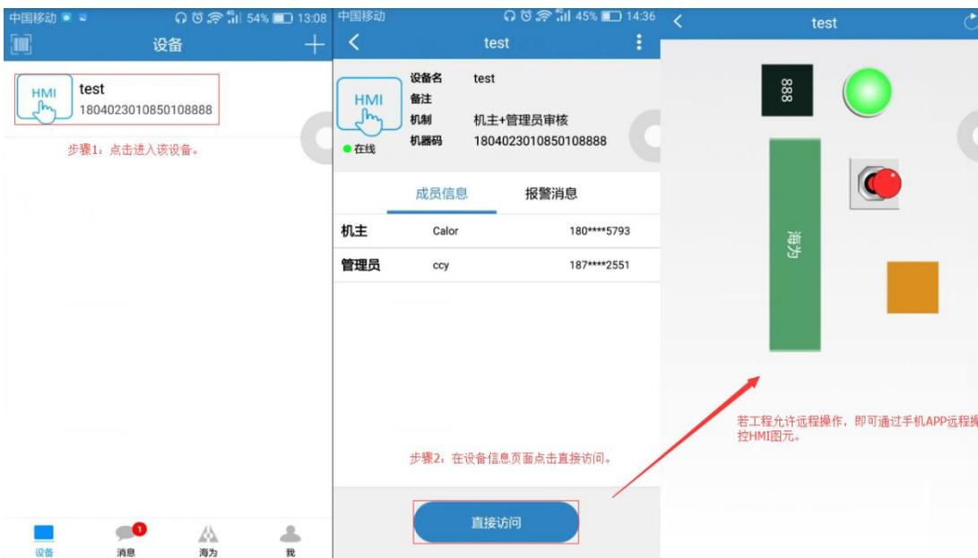
提示：通过 APP 访问 HMI 需满足工程为网络工程；通过 APP 访问并远程控制 HMI 需同时满足工程为网络工程且允许远程操作两个条件。若 HMI 下载的工程未设置【允许远程操作】，则需在组态将工程设置为允许远程操作；若 HMI 下载的工程为本地网络，则需在组态将工程设置为网络工程；上述两个条件设置完成后，将工程下载至 HMI。步骤如下：
